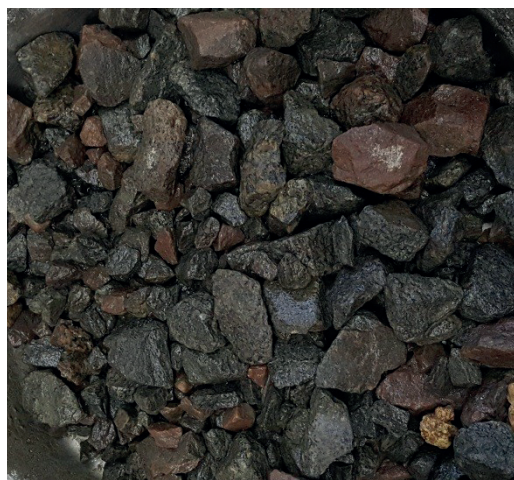
Рис. 2. Общий вид гранитного щебня
