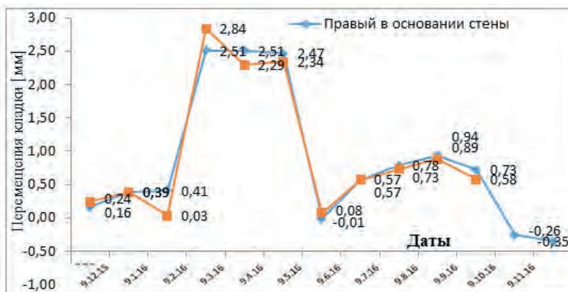
Рис. 20. Горизонтальные перемещения кладки лицевого слоя в основании стены с декабря 2015 г. по ноябрь 2016 г.
