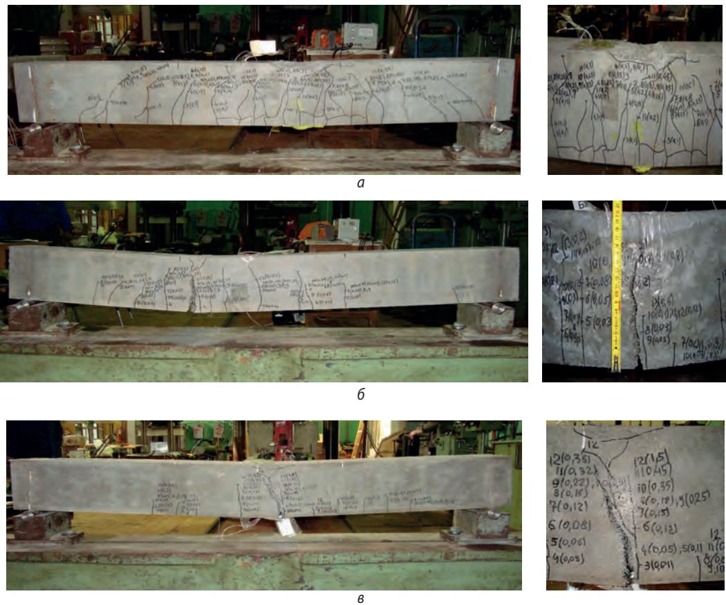
Рис. 8. Характерное разрушение моделей группы: а – Б1; б – Б2; в – Б7
