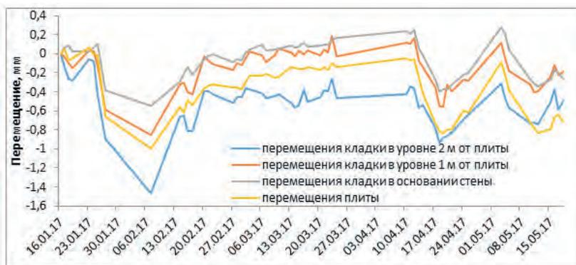
Рис. 22. Горизонтальные перемещения плиты и лицевого слоя на различных уровнях по высоте стены с января 2017 г. по май 2017 г.
