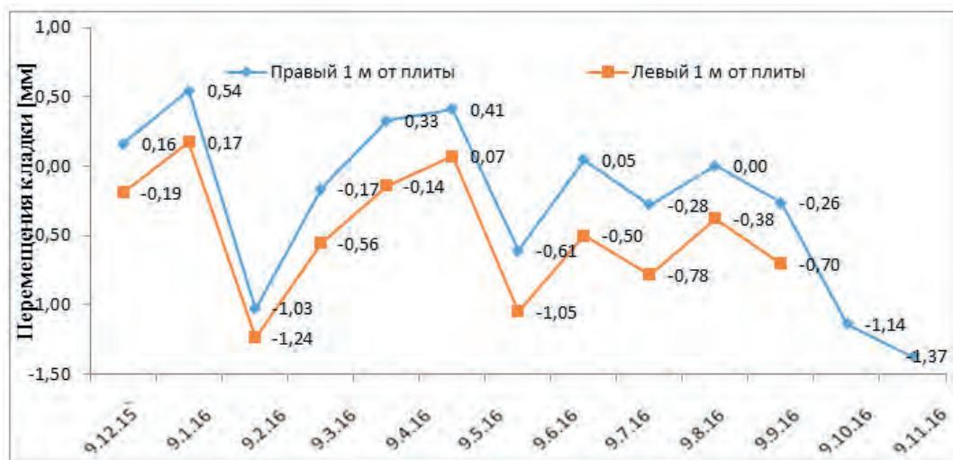
Рис. 19. Горизонтальные перемещения лицевого слоя на высоте 1 м от основания стены с декабря 2015 г. по ноябрь 2016 г.
