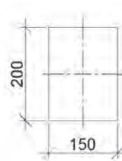
Рис. 3. Поперечное сечение моделей группы Б3, Б8
