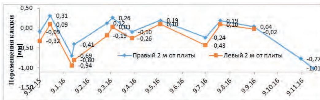
Рис. 18. Горизонтальные перемещения лицевого слоя на высоте 2 м от основания стены с декабря 2015 г. по ноябрь 2016 г.
