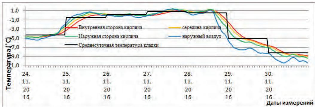
Рис. 16д. Графики изменения температуры наружного воздуха и лицевого слоя в ноябре 2016 г.
