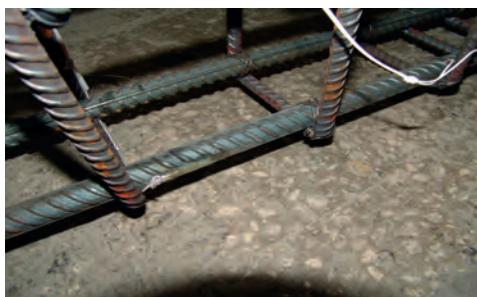
**Рис. 4.** Зачистка поверхности, установка тензорезистора, защита эпоксидной смолой
