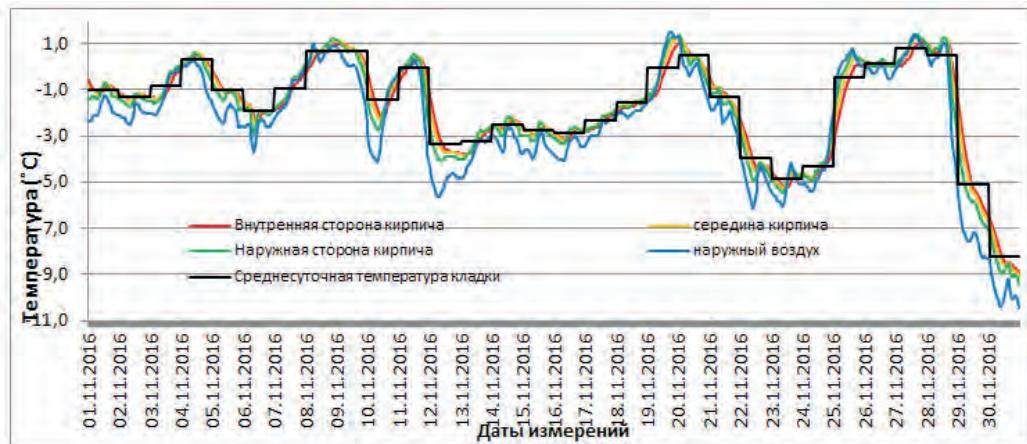
Рис. 16д. Графики изменения температуры наружного воздуха и лицевого слоя в ноябре 2016 г.
