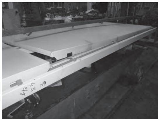
**Рис. 6.** Деформирование направляющей и панели в процессе испытаний
