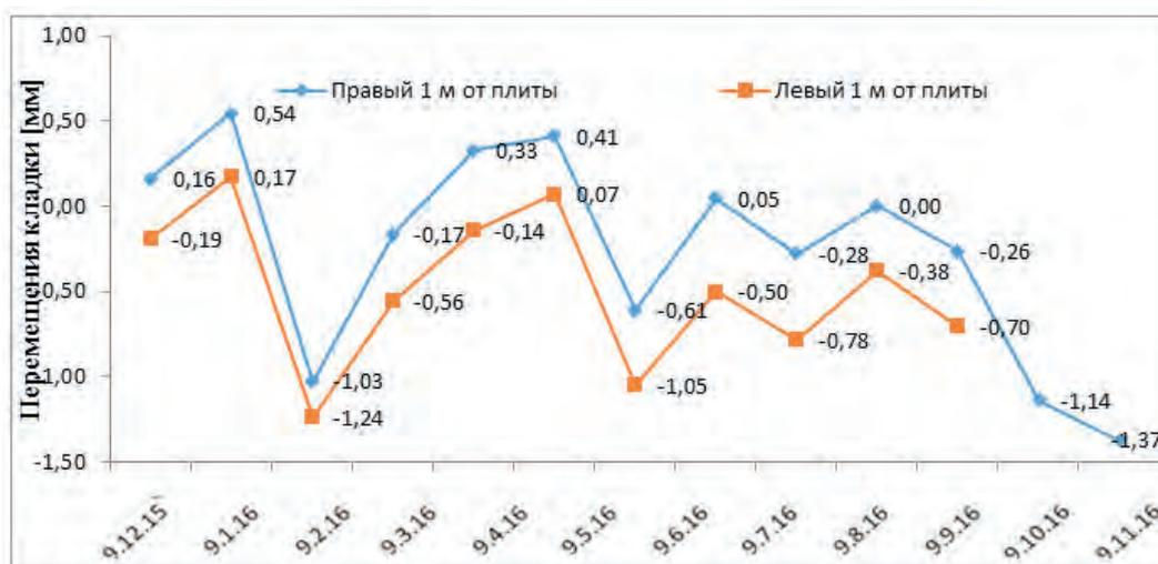
Рис. 19. Горизонтальные перемещения лицевого слоя на высоте 1 м от основания стены с декабря 2015 г. по ноябрь 2016 г.
