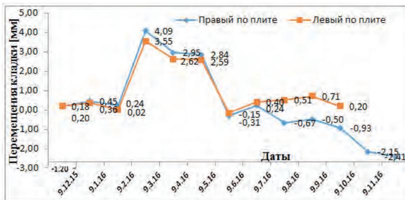
Рис. 21. Горизонтальные перемещения железобетонной плиты со стороны улицы с декабря 2015 г. по ноябрь 2016 г.
