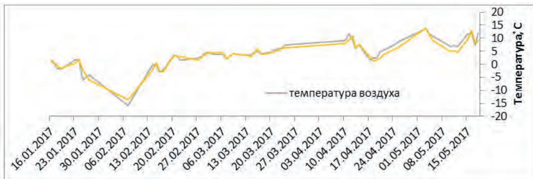
Рис. 17. График зависимости температуры лицевого слоя от температуры наружного воздуха с января 2017 г. по май 2017 г.
