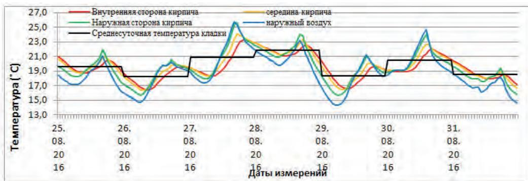
Рис. 16б. Графики изменения температуры наружного воздуха и лицевого слоя в августе 2016 г.
