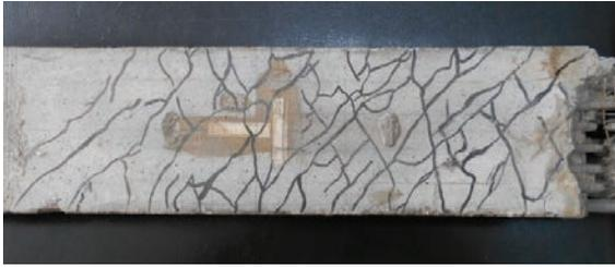
Рис. 1. Опытный образец ТАЦ со следами трещин
