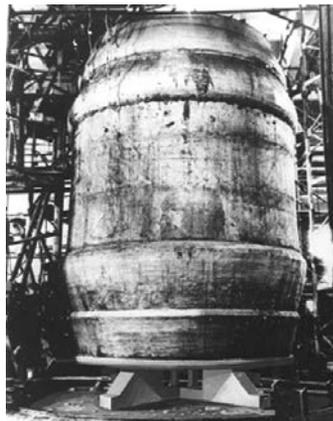
Рис. 8. Модель корпуса реактора из ТАЦ в 1/3 натуральной величины после изготовления
