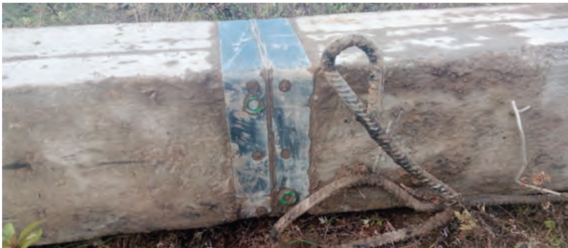
Рис.4. Стык образца № 2 после извлечения
