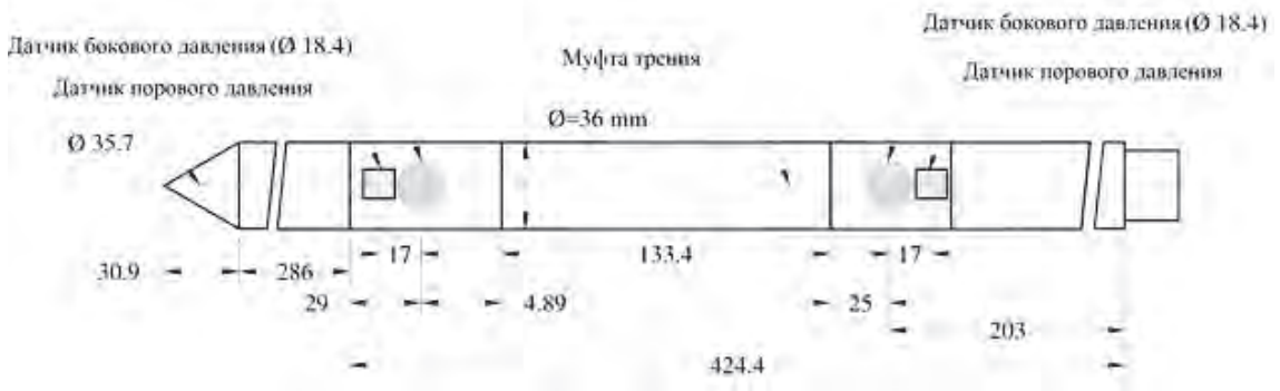
Рис.6. Зонд с датчиком бокового давления и муфтой трения [12]
