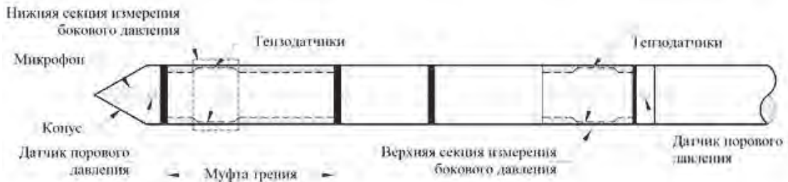
Рис.1. Схема лабораторного зонда с датчиком бокового давления [LSSCP-I] [6]
