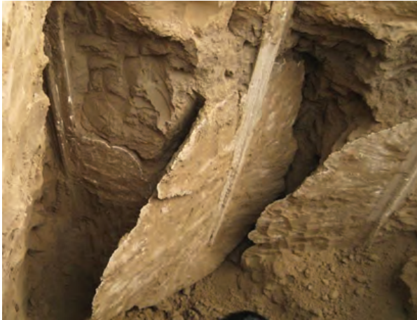
Рис.8. Вид вертикальных плоскостей гидроразрывов по данным Фуминг Ванг (2017)
