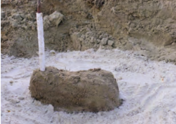
Рис.12. Закрепленный массив песка по направлению горизонтального гидроразрыва (по Сергееву С.В., 2008)
