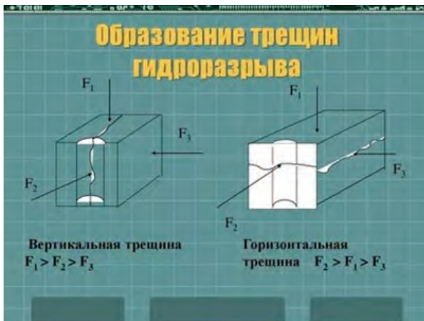
Рис.9. Принцип формирования трещин гидроразрыва, принятый в горном деле, по данным интернет-источника https://ppt-online.org/162743
