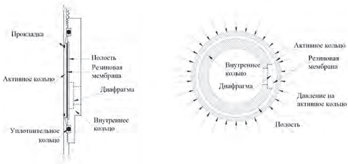
Рис.3. Схема датчика бокового давления зонда LSSCP-III [13]
