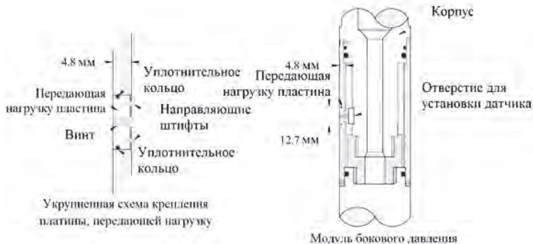
Рис.8. Конструкция датчика бокового давления [5]
