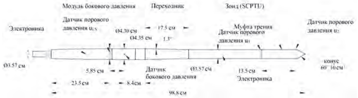
Рис.7. Схема зонда с дополнительным датчиком бокового давления с датчиком порового давления и сейсмодатчиком [5]
