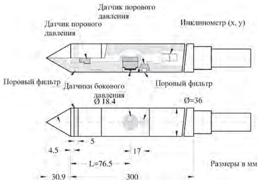
Рис.5. Зонд с датчиком бокового давления [12]
