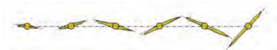
Рис.7. Схема иньекторов (длина 3 м, расстояние между иньекторами 1 м) и полученных гидроразрывов по данным Фуминг Ванг (2017)
