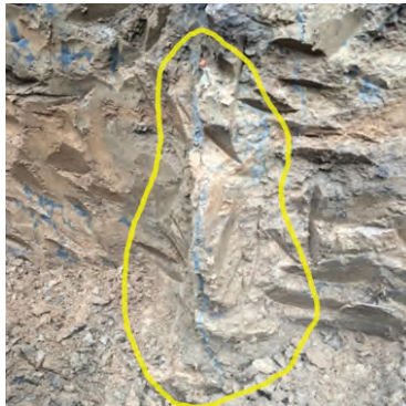
Рис.4. Локальный «прорыв» мембраны в ортогональном направлении (из плоскости сплошной мембраны) на втором слева инъекторе (см. рис. 3)
