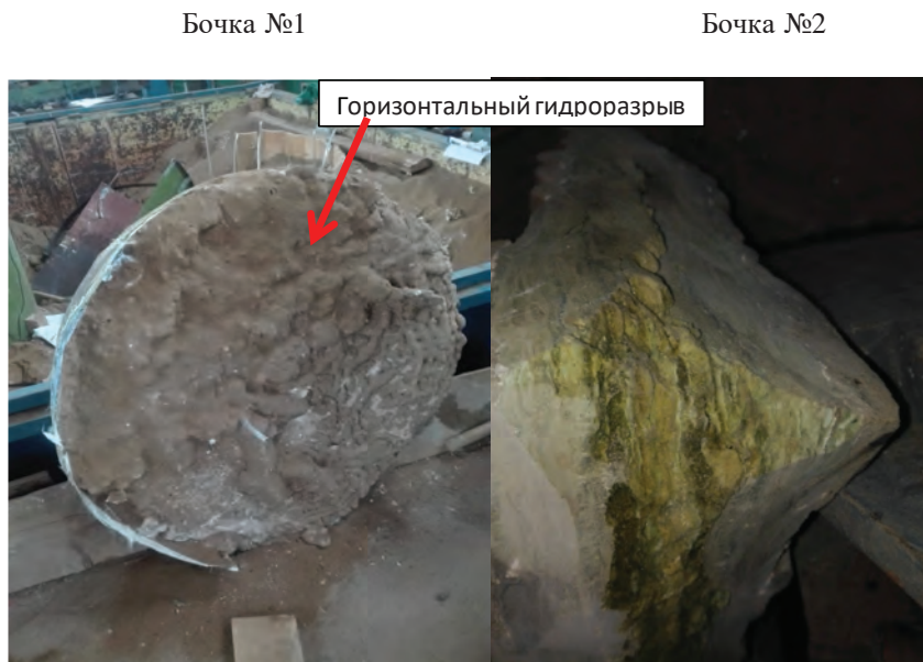
Рис.11. Общий вид извлеченного из бочек полимера, закачанного в режиме гидроразрыва
