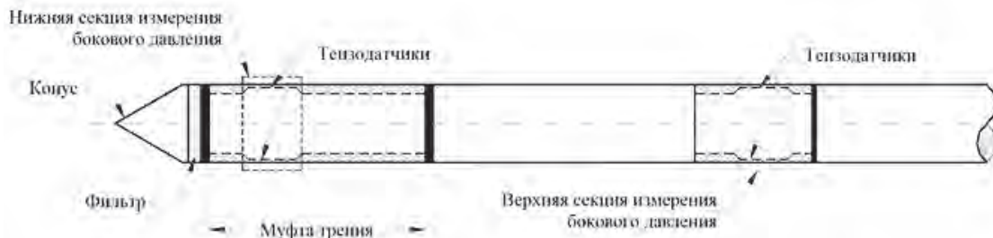
Рис.2. Схема полевого зонда с датчиком бокового давления (LSSCP-II) [7]
