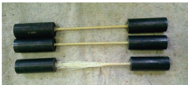
Рис. 8. АСК серии 2 после испытаний на растяжение
