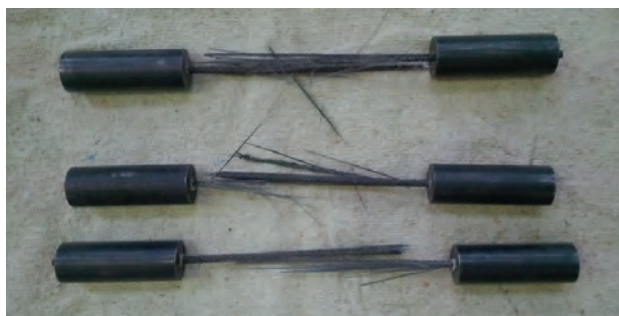
Рис. 9. АСК серии 3 после испытаний на растяжение
