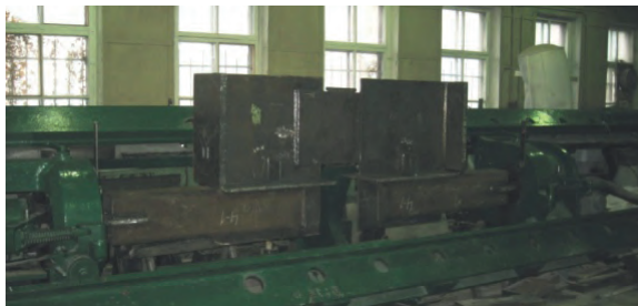
Рис. 5. Испытание образца на растяжение
