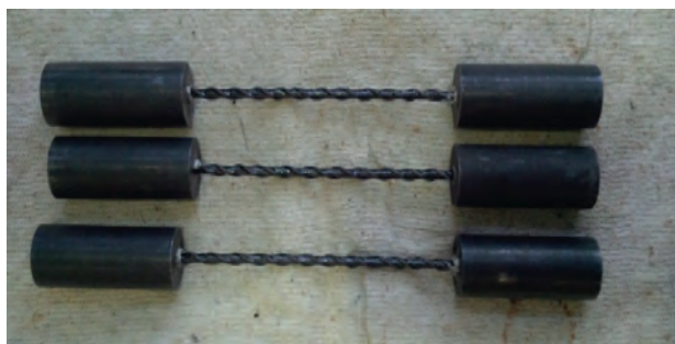
Рис. 7. АСК серии 1 после испытаний на растяжение
