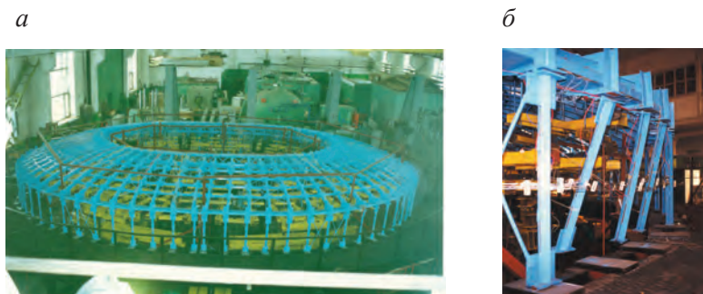
Рис. 3. Испытания модели покрытия: а — общий вид модели; б — выключение из работы трех колонн
