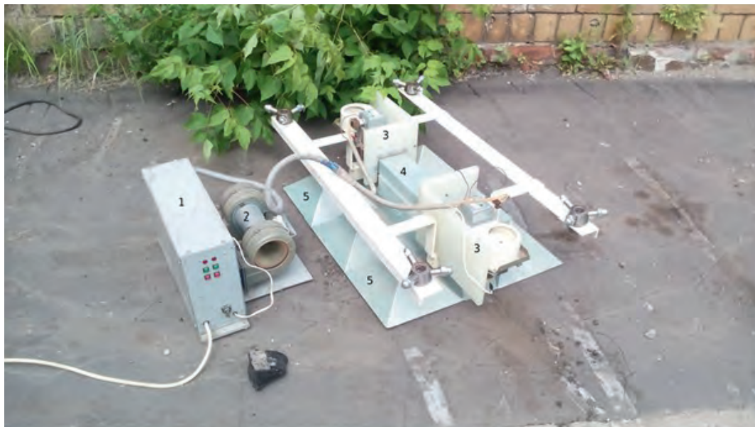
Рис. 1. Опытная лабораторная СВЧ-установка мощностью 0,8-1,0 кВт: 1 — блок питания для магнетронов; 2 — вентилятор с двумя крыльчатками; 3 — магнетроны с вентиляторами; 4 — излучатель щелевой; 5 — СВЧ-защита
