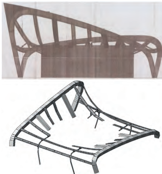
Рис. 6. Конструкции «короны» башни: сверху — фасад (из рабочей документации), снизу — расчетная модель
