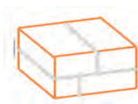
Рис. 3. Объемный элемент периодичности кирпичной кладки (из работы Г.Г. Кашеваровой [11])
