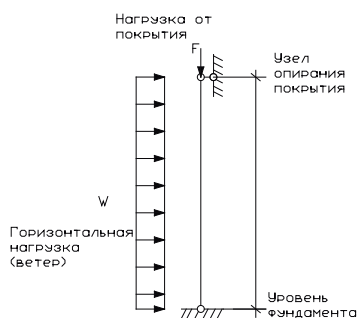
Рис. 3. Расчетная схема элемента
