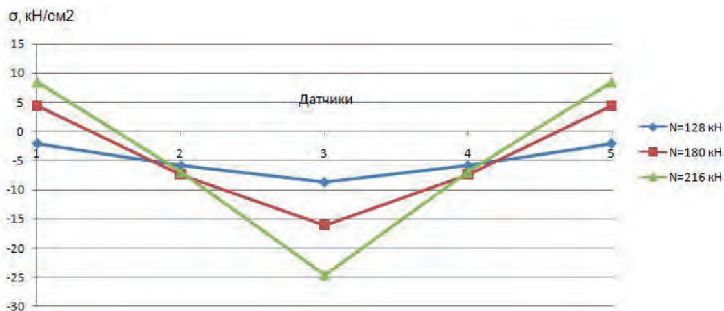
Рис. 7. Экспериментальный анализ эпюр нормальных напряжений в средней части панели
