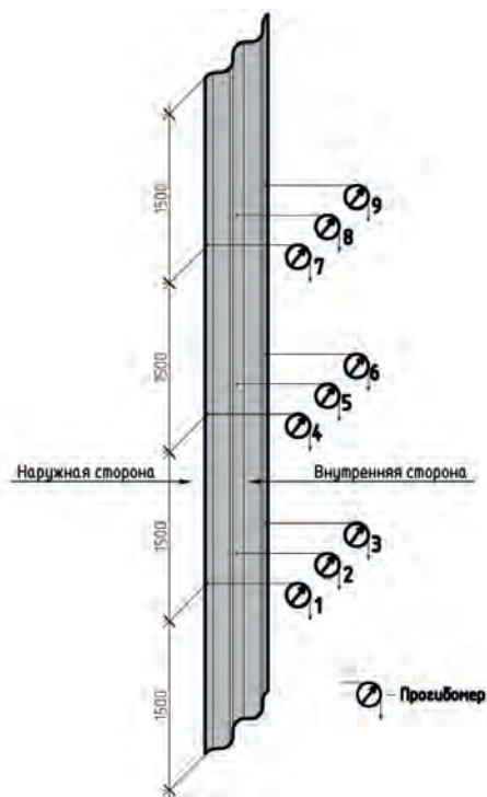
Рис. 5. Схема расположения тензодатчиков
