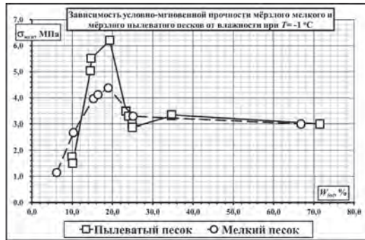
Рис. 3. Зависимость от влажности W_{tot} при температуре T = -1 °C пределов условно-мгновенной прочности на одноосное сжатие \sigma_{мгн} мёрзлых мелкого и пылеватого песков
