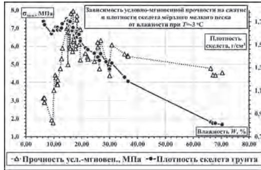
Рис. 7. Зависимость условно-мгновенной прочности на сжатие и плотности скелета мёрзлого мелкого песка от влажности при T = -3\text{ }^{\circ}\text{C}
