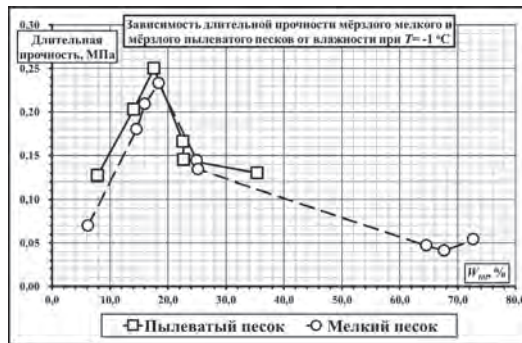
Рис. 4. Зависимость от влажности W_{tot} при температуре T = -1 °C пределов длительной прочности на одноосное сжатие \sigma_{дл} мёрзлых мелкого и пылеватого песков
