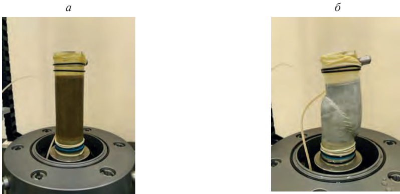
Рис. 3. Образец песчаного грунта до (а) и после (б) испытания
