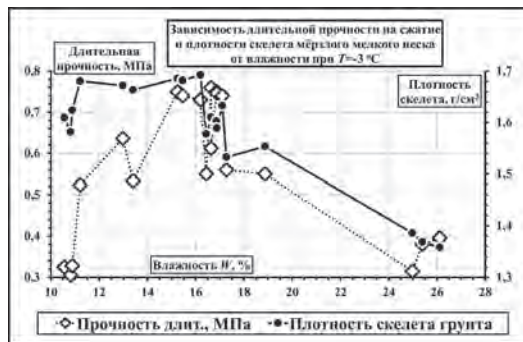
Рис. 8. Зависимость длительной прочности на сжатие и плотности скелета мёрзлого мелкого песка от влажности при T = -3\text{ }^{\circ}\text{C}
