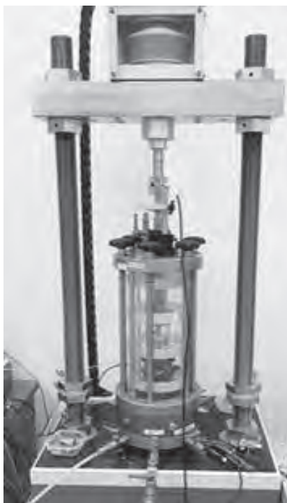
Рис. 1. Прибор трехосного сжатия GDS ELDYN в процессе испытания
