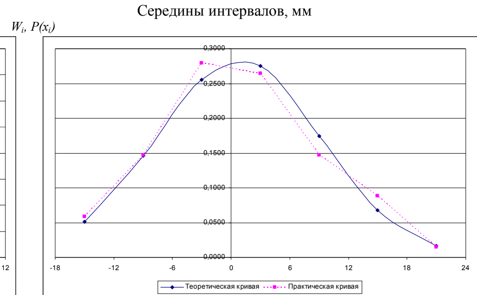
Рис. 3.2. Погрешности изготовления длин ригелей. Объект 1 (главный корпус дрож. завода)
