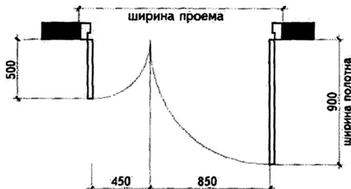
Рисунок 2.12. Двустворчатая дверь. Ширина рабочей зоны дверного полотна 900 мм [47]
