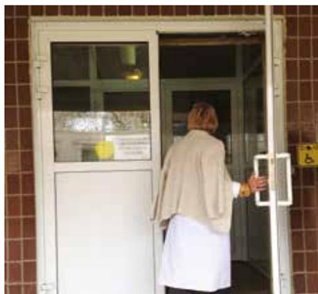
Рисунок 2.17. Пример контрастного оформления дверного полотна или проёма ▶
