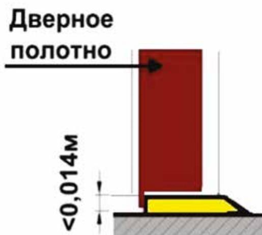
Рисунок 2.9. Параметры порогов согласно СП 59.13300-2016 [53]
