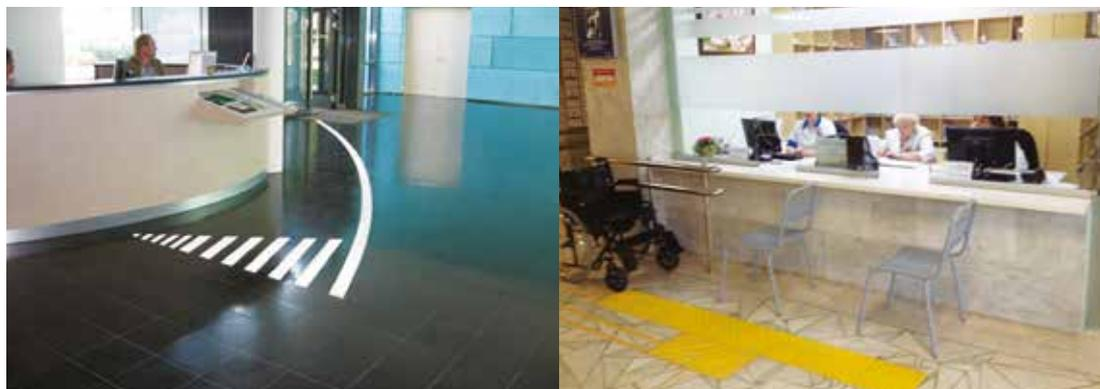
Рисунок 4.11. Пример использования тактильных указателей у прилавков
