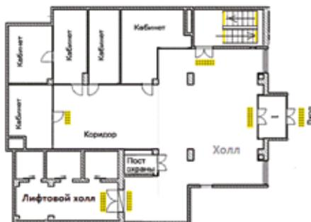
Рисунок 3.9. Примеры обустройства предупреждающих тактильных указателей с конусными рифами внутри здания по СП 59.13300.2016 [53]
