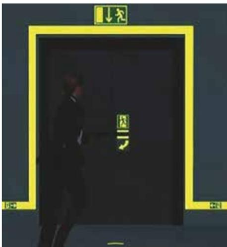
Рисунок 3.12. Использование светонакопительной ленты на путях эвакуации
