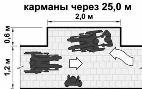
Рисунок 1.4. Пример выполнения зоны для встречного разъезда людей в кресле-коляске для комфортных условий движения [43]
