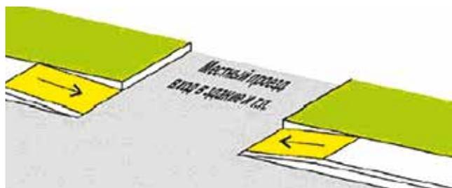
Рисунок 1.11. Пандус, выполненный по ширине тротуара или пешеходной дорожки [45]
