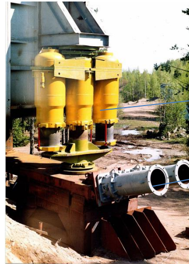
Изоляторы СИС и Пороховые двигатели Стенда СИС
