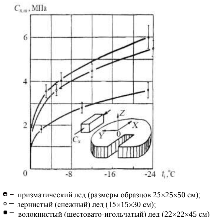
Рисунок П.1 – Зависимость прочности пресноводного льда на одноосное сжатие (при переходе от пластического разрушения к хрупко-пластическому) от температуры ( n = 5 )
