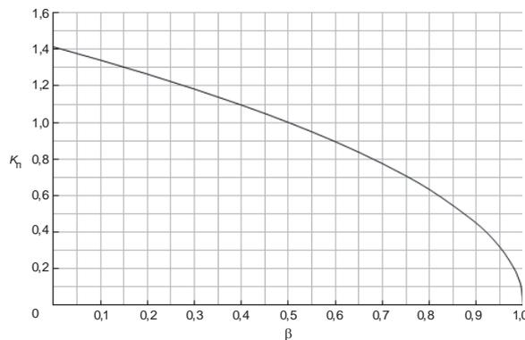
Рисунок Е.1 – Коэффициент  $K_{\Pi}$  для несжимаемой жидкости
