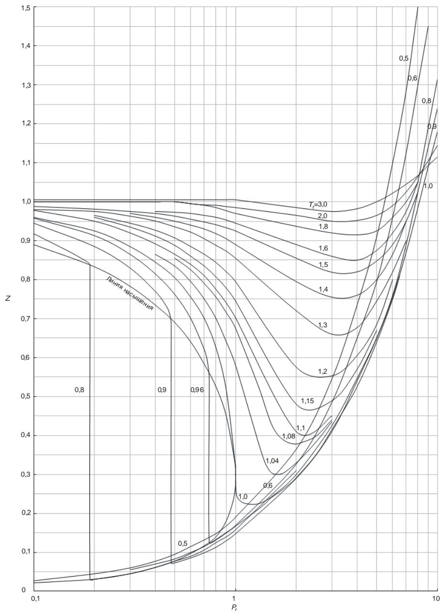
Рисунок И.2 – Зависимость коэффициента сжимаемости  $Z$  от приведенных температуры  $T_r$  и давления  $P_r$
