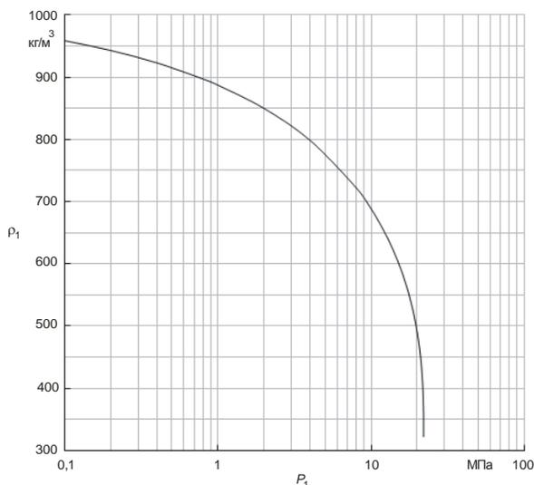
Рисунок Е.13 – Зависимость  $\rho = f(P_1)$  для воды на линии насыщения
