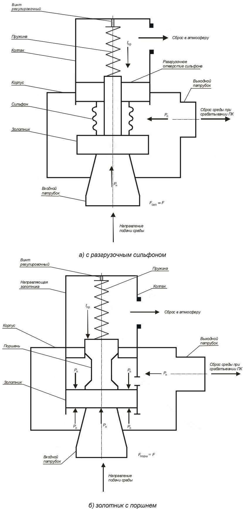
Рисунок В.2 – Статические давления в типовом разгруженном двухпозиционном ПК
