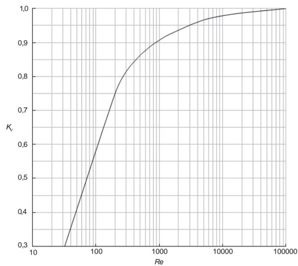
Рисунок И.3 – Зависимость поправочного коэффициента на вязкость  $K_v$  от числа Рейнольдса  $Re$
