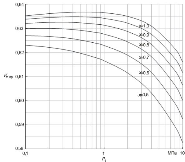
Рисунок Е.9 – Зависимость  $K_{пкр} = f(P_1)$  для влажного водяного пара
