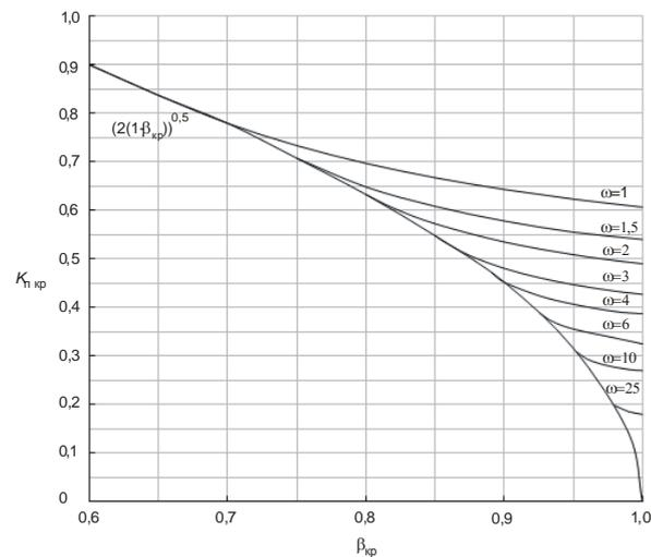
Рисунок Е.8 – Зависимость  $K_{т,кр} = f(\beta_{кр})$  при вскипании жидкости
