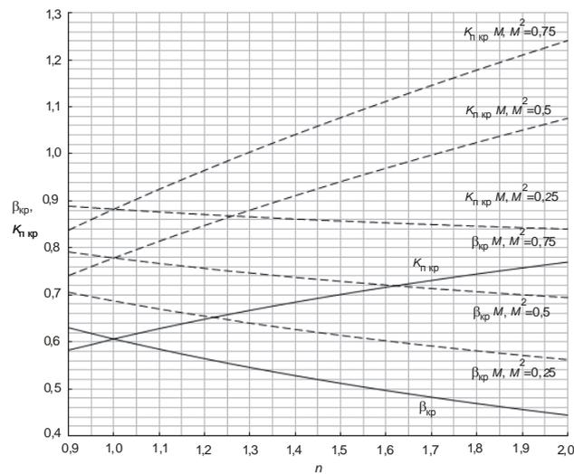
Пр и м е ч а н и е – Пунктиром даны коэффициенты для уравнения постоянного показателя изэнтропы при расчете по комбинации уравнений состояния (таблица Е.2) – в зависимости от числа Маха на входе в клапан
