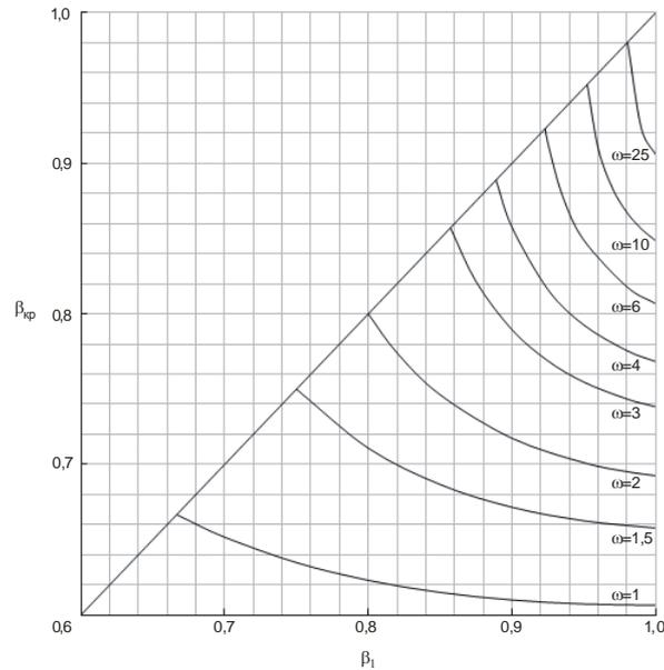
Рисунок Е.7 – Зависимость  $\beta_{кр} = f(\beta_1)$  при вскипании жидкости
