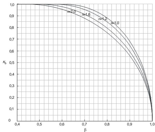
Рисунок Е.5 – Коэффициент  $K_b$  для уравнения постоянного показателя изоэнтропы
