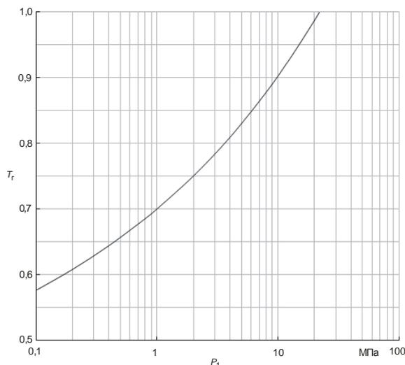
Рисунок Е.12 – Зависимость  $T_r = f(P_1)$  для насыщенных паров воды
