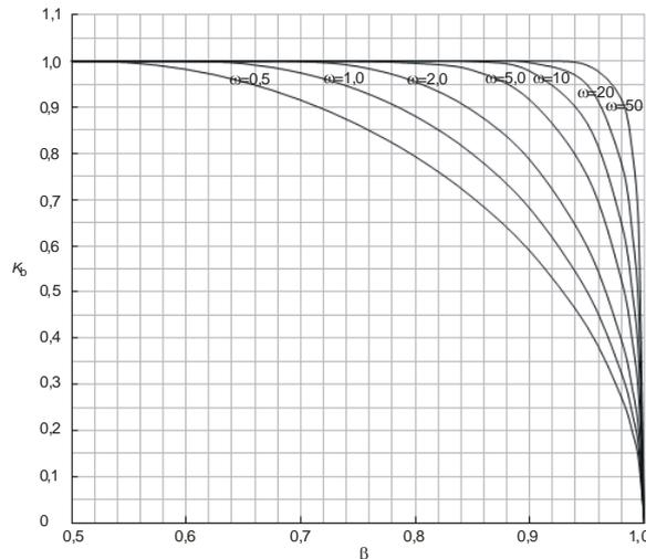
Рисунок Е.6 – Коэффициент  $K_b$  для омега-метода
