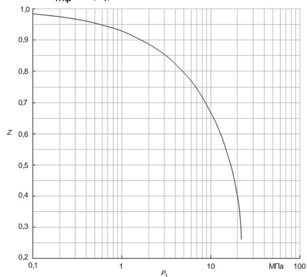
Рисунок Е.11 – Зависимость  $Z = f(P_1)$  для насыщенного водяного пара
