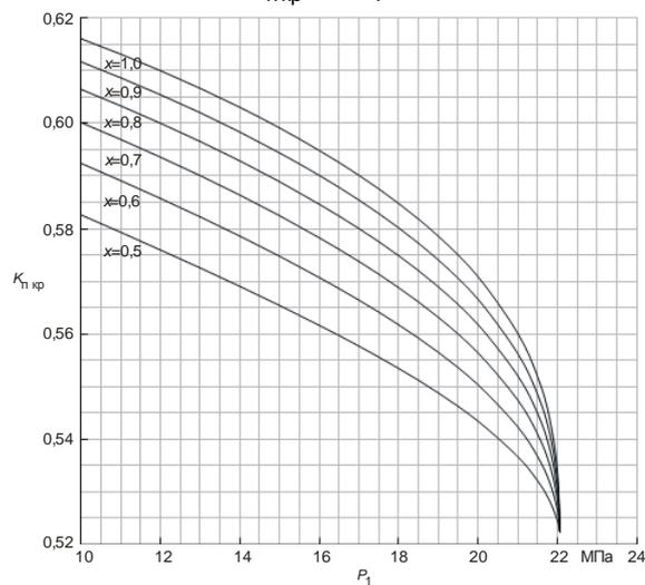
Рисунок Е.10 – Зависимость  $K_{пкр} = f(P_1)$  для влажного водяного пара вблизи критической точки
