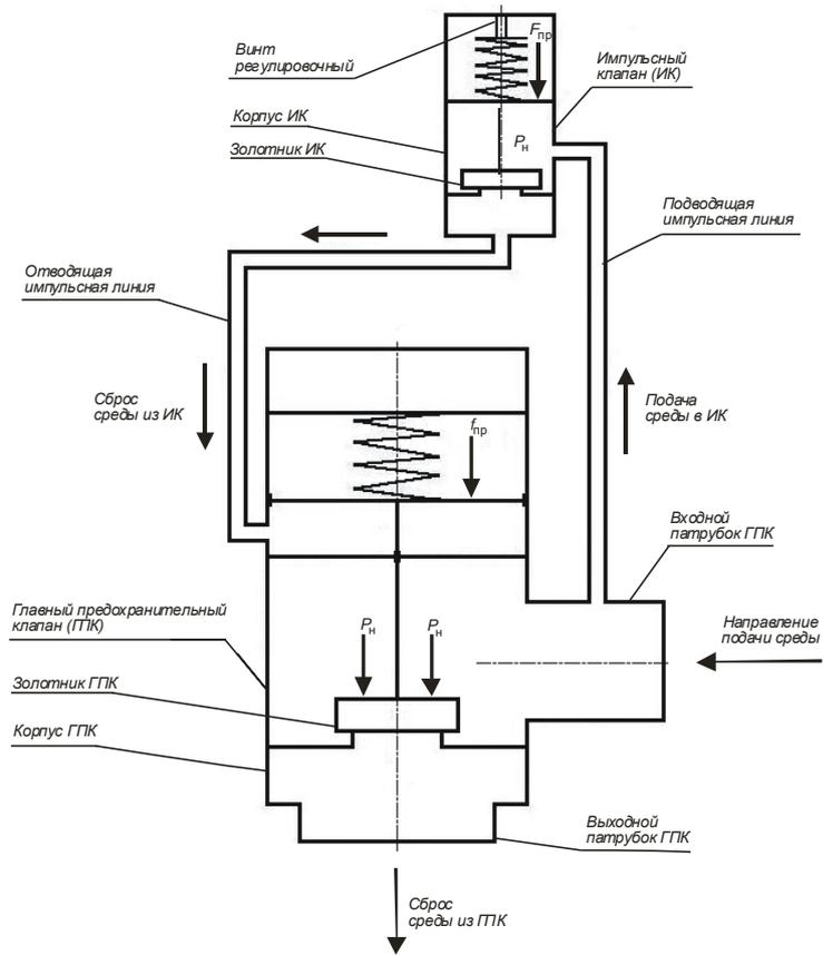
Рисунок В.3 – Импульсно-предохранительное устройство
