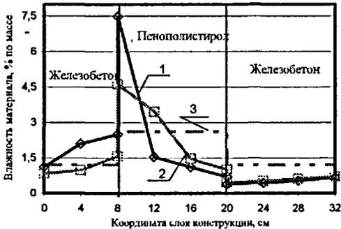
Рис.9. Распределение влажности по трехслойной стеновой панели. 1 – результаты расчета предложенным методом; 2 – результаты расчета методом последовательного увлажнения; 3 – максимальная сорбционная влажность.
