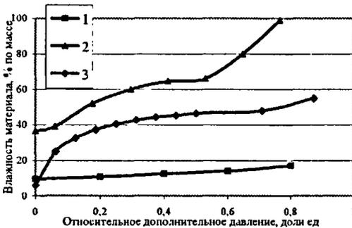
Рис. 4. Изотермы  $w(\psi)$ . (Зависимость влажности от относительного дополнительного давления). 1 – модифицированный полистиролбетон на портландцементе, 420 кг/м<sup>3</sup>; 2 – полистиролбетон на магнезиальном вяжущем, 260 кг/м<sup>3</sup>; 3 – газобетон, 450 кг/м<sup>3</sup>.
