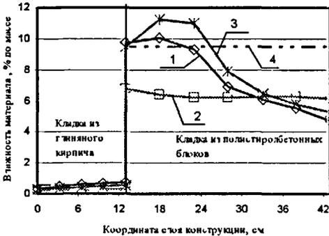
Рис 7 Распределение влажности по толщине стены из полистиролбетонных блоков и облицовочного кирпича. 1 – расчет по предложенному методу; 2 – расчет методом последовательного увлажнения при нестационарных условиях; 3 – то же, при стационарных условиях; 4 – максимальная сорбционная влажность
