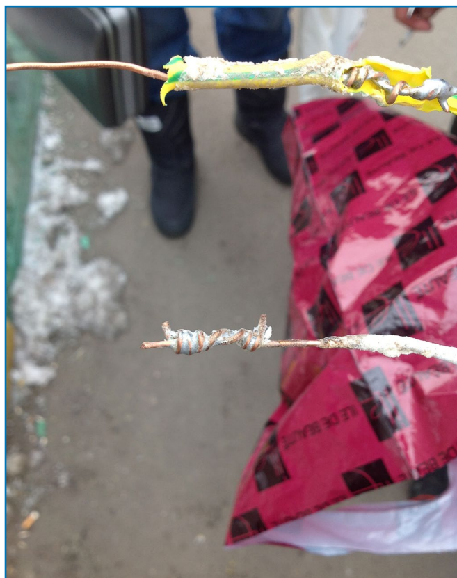
Рисунок 3. Соединение проводника посредством скрутки.
