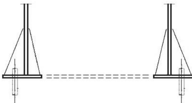
Рисунок 13.2 – Опорная плита с подкрепляющими ребрами
