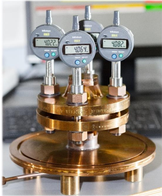
Фланцевое соединение TEMES TA-Luft с датчиками удлинения болтов
