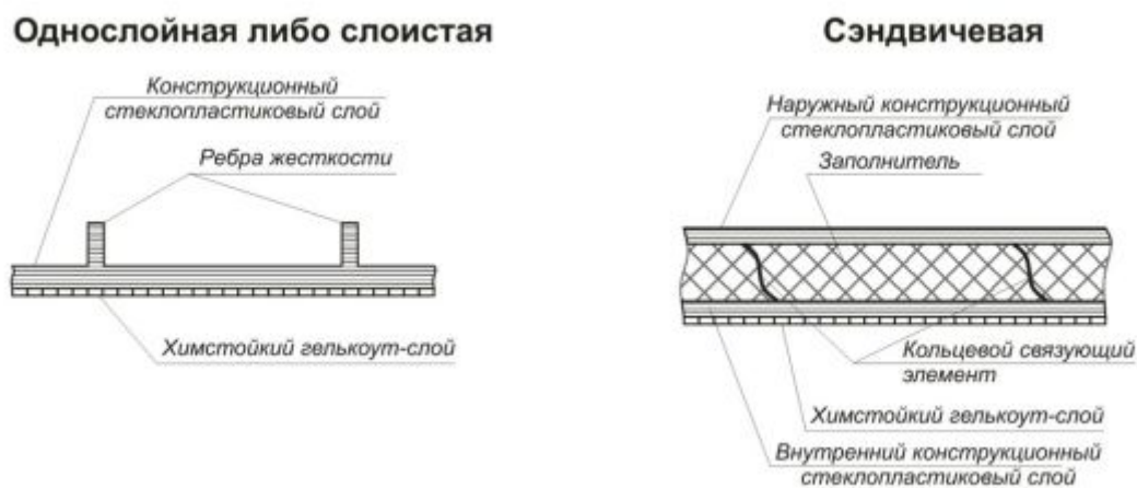
Рисунок 7.1 – Продольные сечения стеклокомпозитных оболочек различных типов
